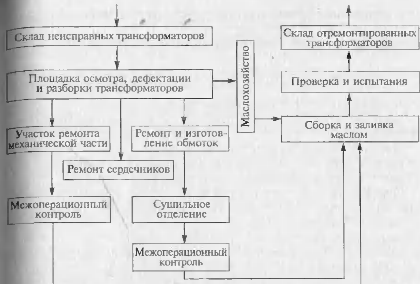
Рис. 13.3. Типовая структурно-технологическая схема ремонта трансформаторов
